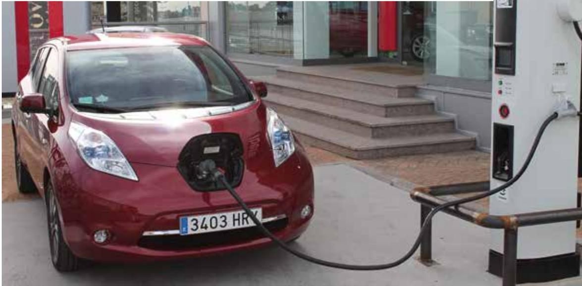
► Poste de carga de rápida según protocolo CHA de MO
