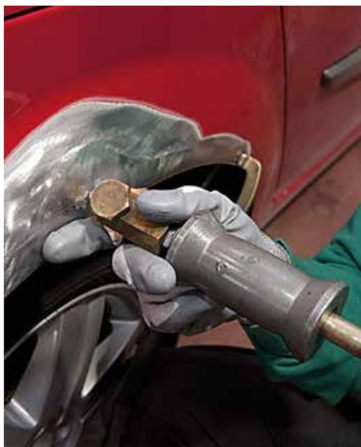
Se basa fundamentalmente en equipos de soldadura por puntos.
