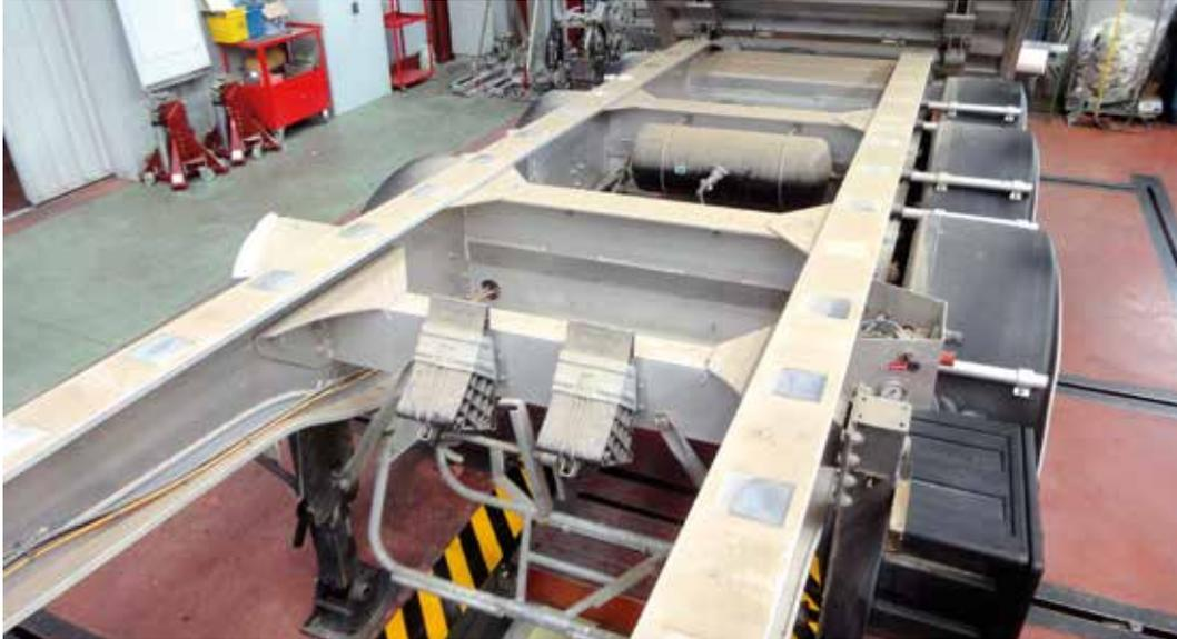
► Bastidor de un semirremolque basculante de aluminio
